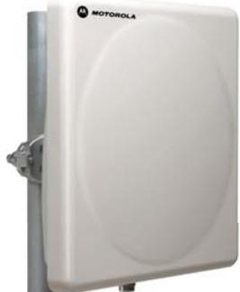
*Беспроводной многоканальный мост конфигурации «точка-точка» четвертого поколения с параметрами работы, задаваемыми программным путем. Устройство сопрягается на канальном (втором) уровне сетевой модели OSI, поддерживает протокол IP и работает в частотных диапазонах 4,9 ГГц, 5,4 ГГц и 5,8 ГГц, обеспечивая **НАСТОЯЩУЮ** производительность как в режиме отсутствия прямой видимости, так и в зоне прямой видимости.*
