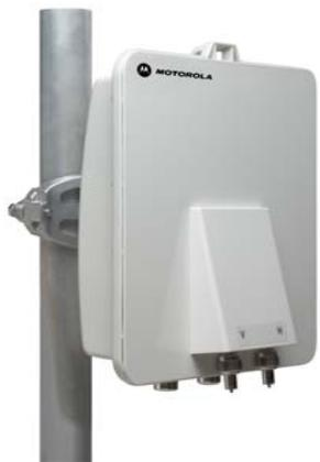
Беспроводной многоканальный мост конфигурации «точка-точка» четвертого поколения с параметрами работы, задаваемыми программным путем. Устройство сопрягается на канальном (втором) уровне сетевой модели OSI, поддерживает протокол IP и работает в частотных диапазонах 5,4 ГГц и 5,8 ГГц, обеспечивая **НАСТОЯЩУЮ** производительность как вне зоны прямой видимости, так и на линии прямой видимости.
